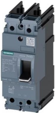
interruttore automatico 3VA5 UL Frame 125 classe del potere di interruzione M 35 kA con 480 V a 2 poli, protezione impianto TM210, FTFM, In=110 A protezione da sovraccarico Ir=110 A con regolazione fissa protezione da cortocircuito Ii=10 x In senza collegamento
