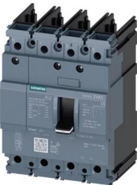
interruttore automatico 3VA5 UL Frame 125 classe del potere di interruzione S 25 kA con 480 V a 4 poli, protezione impianto TM210, FTFM, In=110 A protezione da sovraccarico Ir=110 A con regolazione fissa protezione da cortocircuito Ii=10 x In protezione del conduttore di neutro 100 % senza collegamento
