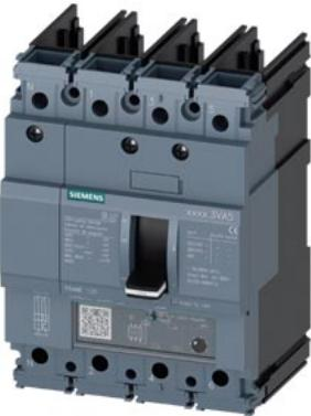
interruttore automatico 3VA5 UL Frame 125 classe del potere di interruzione H 65 kA con 480 V a 4 poli, protezione impianto TM230, FTAM, In=100 A protezione da sovraccarico Ir=100 A con regolazione fissa protezione da cortocircuito Ii=5 ... 10 x In protezione del conduttore di neutro 100 % senza collegamento
