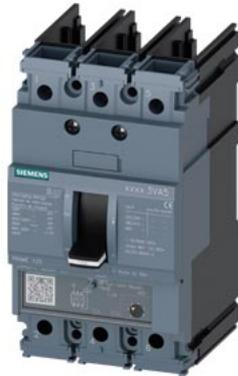
interruttore automatico 3VA5 UL Frame 125 classe del potere di interruzione H 65 kA con 480 V a 3 poli, protezione impianto TM230, FTAM, In=100 A protezione da sovraccarico Ir=100 A con regolazione fissa protezione da cortocircuito li=5 ... 10 x In senza collegamento
