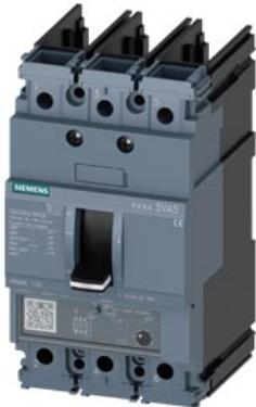
interruttore automatico 3VA5 UL Frame 125 classe del potere di interruzione M 35 kA con 480 V a 3 poli, protezione impianto TM230, FTAM, In=100 A protezione da sovraccarico Ir=100 A con regolazione fissa protezione da cortocircuito I<sub>c</sub>=5 ... 10 x In UL 489 SB (Naval), 50°C senza collegamento
