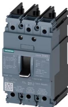
interruttore scatolato 3VA5 UL Frame 125 potere di interruzione in cortocircuito max. 65 kA con 480 V a 3 poli, protezione impianto MCS110,  $I_n=100$  A senza protezione da sovraccarico protezione intrinseca  $I_i=16 \times I_n$  senza collegamento
