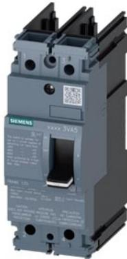
interruttore scatolato 3VA5 UL Frame 125 potere di interruzione in cortocircuito max. 65 kA con 480 V a 2 poli, protezione impianto MCS110,  $I_n=100$  A senza protezione da sovraccarico protezione intrinseca  $I_i=16 \times I_n$  senza collegamento
