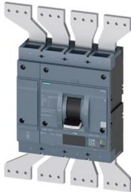
interruttore automatico 3VA2 IEC frame 1250 classe del potere di interruzione C Icu=110 kA con 415V a 4 poli, protezione impianto ETU550, LSI, In=1250 A protezione da sovraccarico Ir=500A ... 1250A protezione da cortocircuito I<sub>sd</sub>=0,6..10x I<sub>n</sub>, I<sub>li</sub>=1,5...10x I<sub>n</sub> protezione del conduttore di neutro impostabile (OFF, fino al 100%) attacco a sbarra divaricato
