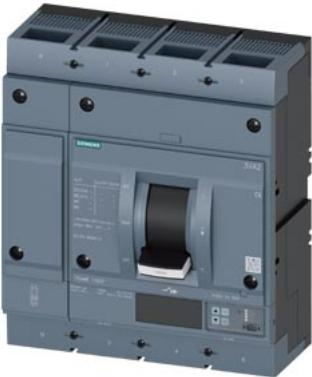
interruttore automatico 3VA2 IEC Frame 1000 classe del potere di interruzione H Icu=85 kA con 415 V a 4 poli, protezione impianto ETU550, LSI, In=800 A protezione da sovraccarico Ir=320 A ... 800 A protezione da cortocircuito Isd=0,6 ... 10 x In, li=1,5 ... 10 x In protezione del conduttore di neutro impostabile (OFF, fino al 160%) attacchi piatti a vite
