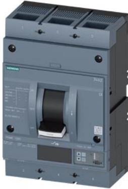
interruttore automatico 3VA2 IEC Frame 1000 classe del potere di interruzione M Icu=55 kA con 415 V a 3 poli, protezione impianto ETU860, LSIG, In=800 A protezione da sovraccarico Ir=320 A ... 800 A protezione da cortocircuito Isd=0,6 ... 10 x In, li=1,5 ... 10 x In protezione del conduttore di neutro opzionale con, esterno, trasformatore di corrente, fino al 160 % protezione da guasto verso terra, disinseribile Ig=0,2 ... 1 x In, tg=0,05...0,8s attacchi piatti a vite
