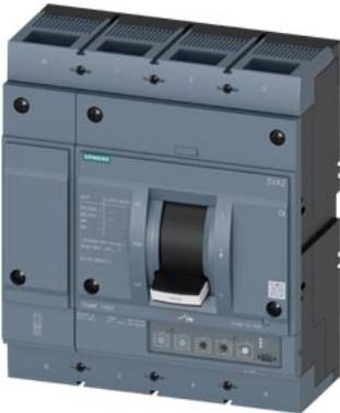
Interruttore 3VA2 IEC Frame 1000 Classe del potere di interruzione C Icu=110kA @ 415V a 4 poli, protezione impianto ETU350, LSI, In=630 A protezione da sovraccarico Ir=250 A ... 630 A protezione da cortocircuito Isd=1,5...10 x Ir, li=12 x In protezione del conduttore di neutro impostabile (OFF, 50%, 100%) attacco piatto a vite
