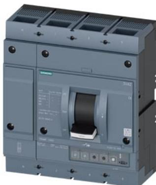
Interruttore 3VA2 IEC Frame 1000 Classe del potere di interruzione C Icu=110kA @ 415V a 4 poli, protezione impianto ETU330, LIG, In=630 A protezione da sovraccarico Ir=250 A ... 630 A protezione da cortocircuito Ii=1,5...12 x In protezione del conduttore di neutro impostabile (OFF, 50%, 100%) protezione da guasto verso terra Ig=0,2...1 x In= tg=0,1/0,3s attacco piatto a vite
