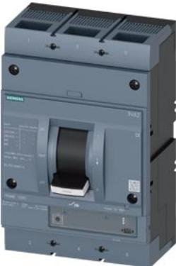
Interruttore 3VA2 IEC Frame 1000 Classe del potere di interruzione C Icu=110kA @ 415V a 3 poli, protezione impianto ETU340, ELISA LI, In=630 A protezione da sovraccarico Ir=250 A ... 630 A protezione da cortocircuito Ii=12 x In attacco piatto a vite
