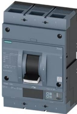
Interruttore 3VA2 IEC Frame 1000 Classe del potere di interruzione H Icu=85kA @ 415V a 3 poli, protezione impianto ETU550, LSI, In=630 A protezione da sovraccarico Ir=250 A ... 630 A protezione da cortocircuito I<sub>sd</sub>=0,6..10x In, I<sub>i</sub>=1,5..12x In protezione del conduttore di neutro opzionale con trasformatore di corrente, fino a 160% attacco piatto a vite
