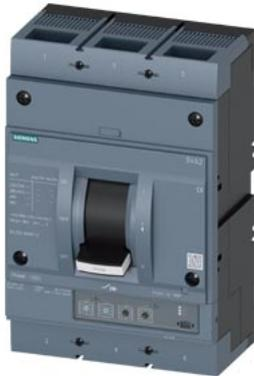
Interruttore 3VA2 IEC Frame 1000 Classe del potere di interruzione H Icu=85kA @ 415V a 3 poli, protezione impianto ETU330, LIG, In=630 A protezione da sovraccarico Ir=250 A ... 630 A protezione da cortocircuito li=1,5...12 x In protezione da guasto verso terra Ig=0,2...1 x In, tg=0,1/0,3s attacco piatto a vite
