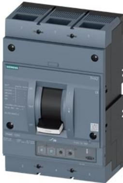
Interruttore 3VA2 IEC Frame 1000 Classe del potere di interruzione M Icu=55kA @ 415V a 3 poli, protezione impianto ETU350, LSI, In=630 A protezione da sovraccarico Ir=250 A ... 630 A protezione da cortocircuito I<sub>sd</sub>=1,5...10 x I<sub>r</sub>, I<sub>i</sub>=12 x I<sub>n</sub> attacco piatto a vite
