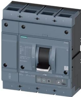
Interruttore 3VA2 IEC Frame 1000 Classe del potere di interruzione M Icu=55kA @ 415V a 4 poli, protezione impianto ETU320, LI, In=630 A protezione da sovraccarico Ir=250 A ... 630 A protezione da cortocircuito Ii=1,5...12 x In protezione del conduttore di neutro impostabile (OFF, 50%, 100%) attacco piatto a vite
