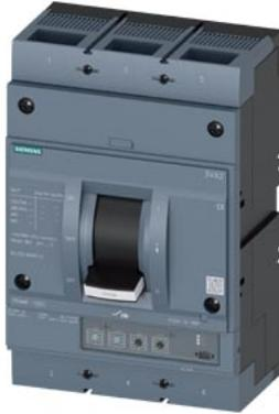
Interruttore 3VA2 IEC Frame 1000 Classe del potere di interruzione C Icu=110kA @ 415V a 3 poli, protezione impianto ETU330, LIG, In=1000A protezione da sovraccarico Ir=400 A ... 1000 A protezione da cortocircuito li=1,5...10 x In protezione da guasto verso terra Ig=0,2...1 x In, tg=0,1/0,3s attacco piatto a vite
