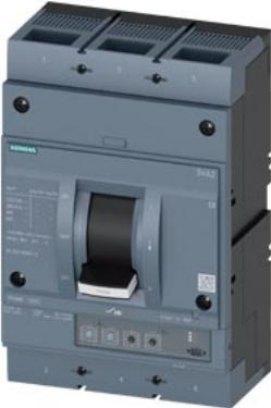
Interruttore 3VA2 IEC Frame 1000 Classe del potere di interruzione H Icu=85kA @ 415V a 3 poli, protezione impianto ETU330, LIG, In=1000A protezione da sovraccarico Ir=400 A ... 1000 A protezione da cortocircuito Ii=1,5...10 x In protezione da guasto verso terra Ig=0,2...1 x In, tg=0,1/0,3s attacco piatto a vite
