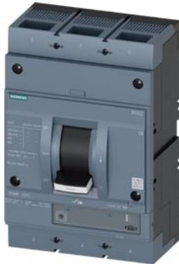
Interruttore 3VA2 IEC Frame 1000 Classe del potere di interruzione H Icu=85kA @ 415V a 3 poli, protezione impianto ETU340, ELISA LI, In=1000A protezione da sovraccarico Ir=400 A ... 1000 A protezione da cortocircuito li=10 x In attacco piatto a vite
