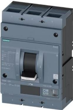
Interruttore 3VA2 IEC Frame 1000 Classe del potere di interruzione M Icu=55kA @ 415V a 3 poli, protezione impianto ETU860, LSIG, In=1000A protezione da sovraccarico Ir=400 A ... 1000 A protezione da cortocircuito Isd=0,6..10x In, Ii=1,5..10x In protezione del conduttore di neutro opzionale con trasformatore di corrente, fino a 160% protezione da guasto verso terra, disinseribile Ig=0,2...1 x In, tg=0,05-0,8s attacco piatto a vite
