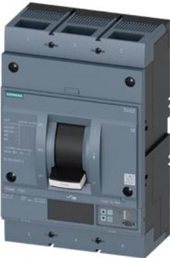
Interruttore 3VA2 IEC Frame 1000 Classe del potere di interruzione M Icu=55kA @ 415V a 3 poli, protezione impianto ETU550, LSI, In=1000A protezione da sovraccarico Ir=400 A ... 1000 A protezione da cortocircuito Isd=0,6..10x In, Ii=1,5..10x In protezione del conduttore di neutro opzionale con trasformatore di corrente, fino a 160% attacco piatto a vite
