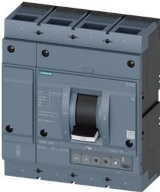
Interruttore 3VA2 IEC Frame 1000 Classe del potere di interruzione M Icu=55kA @ 415V a 4 poli, protezione impianto ETU350, LSI, In=1000A protezione da sovraccarico Ir=400 A ... 1000 A protezione da cortocircuito I<sub>sd</sub>=1,5...10 x I<sub>r</sub>, I<sub>i</sub>=10 x I<sub>n</sub> protezione del conduttore di neutro impostabile (OFF, 50%, 100%) attacco piatto a vite
