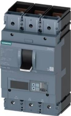
Interruttore 3VA2 IEC Frame 630 Classe del potere di interruzione L Icu=150kA @ 415V a 3 poli, protezione impianto ETU850, LSI, In=630 A protezione da sovraccarico Ir=250 A ... 630 A protezione da cortocircuito Isd=0,6..9x In, li=1,5..9x In protezione del conduttore di neutro opzionale con trasformatore di corrente, fino a 160% attacco piatto a vite
