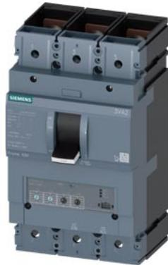
Interruttore 3VA2 IEC Frame 630 Classe del potere di interruzione C Icu=110kA @ 415V a 3 poli, protezione impianto ETU350, LSI, In=630 A protezione da sovraccarico Ir=250 A ... 630 A protezione da cortocircuito I<sub>sd</sub>=1,5...9x I<sub>r</sub>, I<sub>i</sub>=9x I<sub>n</sub> attacco piatto a vite
