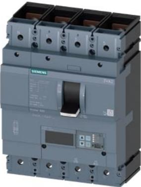
Interruttore 3VA2 IEC Frame 630 Classe del potere di interruzione H Icu=85kA @ 415V a 4 poli, protezione impianto ETU860, LSIG, In=630 A protezione da sovraccarico Ir=250 A ... 630 A protezione da cortocircuito Isd=0,6..9x In, li=1,5..9x In protezione del conduttore di neutro impostabile (OFF, fino a 100%) protezione da guasto verso terra, disinseribile Ig=0,2...1 x In= tg=0,05-0,8s attacco piatto a vite
