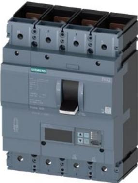
Interruttore 3VA2 IEC Frame 630 Classe del potere di interruzione H Icu=85kA @ 415V a 4 poli, protezione impianto ETU560, LSIG, In=630 A protezione da sovraccarico Ir=250 A ... 630 A protezione da cortocircuito Isd=0,6..9x In, li=1,5..9x In protezione del conduttore di neutro impostabile (OFF, fino a 100%) protezione da guasto verso terra, disinseribile Ig=0,2...1 x In= tg=0,05-0,8s attacco piatto a vite
