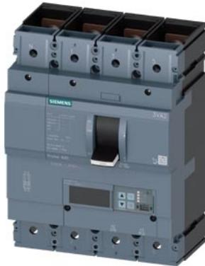
Interruttore 3VA2 IEC Frame 630 Classe del potere di interruzione H Icu=85kA @ 415V a 4 poli, protezione impianto ETU550, LSI, In=630 A protezione da sovraccarico Ir=250 A ... 630 A protezione da cortocircuito I<sub>sd</sub>=0,6..9x I<sub>n</sub>, I<sub>i</sub>=1,5..9x I<sub>n</sub> protezione del conduttore di neutro impostabile (OFF, fino a 100%) attacco piatto a vite
