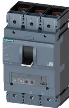
Interruttore 3VA2 IEC Frame 630 Classe del potere di interruzione H Icu=85kA @ 415V a 3 poli, protezione impianto ETU350, LSI, In=630 A protezione da sovraccarico Ir=250 A ... 630 A protezione da cortocircuito I<sub>sd</sub>=1,5...9x I<sub>r</sub>, I<sub>i</sub>=9x I<sub>n</sub> attacco piatto a vite
