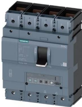
Interruttore 3VA2 IEC Frame 630 Classe del potere di interruzione M Icu=55kA @ 415V a 4 poli, protezione impianto ETU350, LSI, In=630 A protezione da sovraccarico Ir=250 A ... 630 A protezione da cortocircuito I<sub>sd</sub>=1,5...9x I<sub>r</sub>, I<sub>i</sub>=9x I<sub>n</sub> protezione del conduttore di neutro impostabile (OFF, 50%, 100%) attacco piatto a vite
