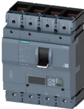
interruttore automatico 3VA2 IEC Frame 630 classe del potere di interruzione E Icu=200 kA con 415 V a 4 poli, protezione impianto ETU860, LSIG, In=630 A protezione da sovraccarico Ir=250 A ... 630 A protezione da cortocircuito Isd=0,6 ... 9x In, li=1,5 ... 9x In protezione del conduttore di neutro impostabile (OFF, fino a 100%) attacchi piatti a vite
