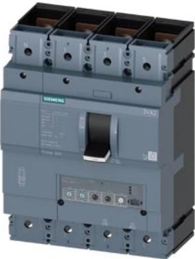
interruttore automatico 3VA2 IEC Frame 630 classe del potere di interruzione E Icu=200 kA con 415 V a 4 poli, protezione impianto ETU330, LIG, In=630 A protezione da sovraccarico Ir=250 A ... 630 A protezione da cortocircuito Ii=1,5 ... 9 x In protezione del conduttore di neutro impostabile (OFF, 50 %, 100 %) protezione da guasto verso terra Ig=0,2 ... 1 x In, tg=0,1/0,3s attacchi piatti a vite
