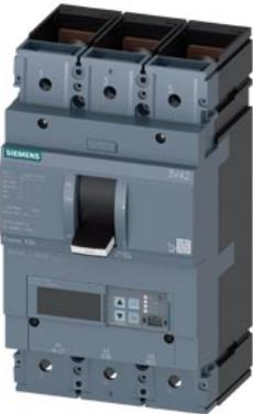
Interruttore 3VA2 IEC Frame 630 Classe del potere di interruzione C Icu=110kA @ 415V a 3 poli, protezione impianto ETU560, LSIG, In=500A protezione da sovraccarico Ir=200 A ... 500 A protezione da cortocircuito Isd=0,6..10x In, Ii=1,5..14x In protezione del conduttore di neutro opzionale con trasformatore di corrente, fino a 160% protezione da guasto verso terra, disinseribile Ig=0,2...1 x In, tg=0,05-0,8s attacco piatto a vite
