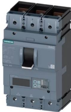
Interruttore 3VA2 IEC Frame 630 Classe del potere di interruzione M Icu=55kA @ 415V a 3 poli, protezione motore ETU860M, LSIG, In=500A protezione da sovraccarico Ir=200 A ... 500 A protezione da cortocircuito I<sub>sd</sub>=1,2..15x I<sub>n</sub>, I<sub>i</sub>=3..15x I<sub>n</sub> protezione da guasto verso terra, disinseribile I<sub>g</sub>=0,2...1 x I<sub>n</sub>, tg=0,05-0,8s attacco piatto a vite
