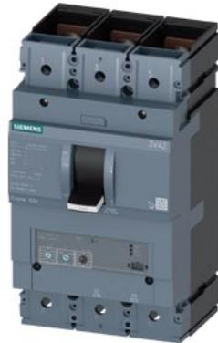
Interruttore 3VA2 IEC Frame 630 Classe del potere di interruzione M Icu=55kA @ 415V a 3 poli, protezione motore ETU350M, LSI, In=500A protezione da sovraccarico Ir=200 A ... 500 A protezione da cortocircuito Isd=3...15 x Ir, li=15 x In attacco piatto a vite
