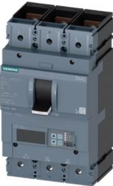
Interruttore 3VA2 IEC Frame 630 Classe del potere di interruzione M Icu=55kA @ 415V a 3 poli, protezione impianto ETU860, LSIG, In=500A protezione da sovraccarico Ir=200 A ... 500 A protezione da cortocircuito Isd=0,6..10x In, Ii=1,5..14x In protezione del conduttore di neutro opzionale con trasformatore di corrente, fino a 160% protezione da guasto verso terra, disinseribile Ig=0,2...1 x In, tg=0,05-0,8s attacco piatto a vite
