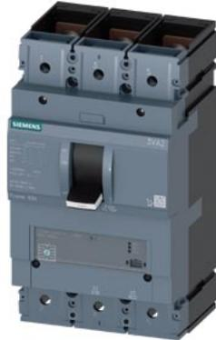
Interruttore 3VA2 IEC Frame 630 Classe del potere di interruzione M Icu=55kA @ 415V a 3 poli, protezione impianto ETU340, ELISA LI, In=500A protezione da sovraccarico Ir=200 A ... 500 A protezione da cortocircuito li=14 x In attacco piatto a vite
