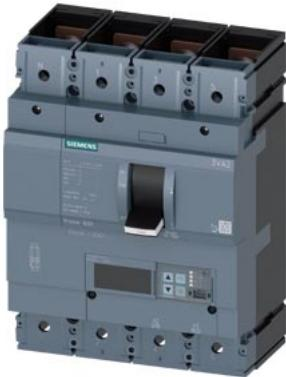
Interruttore 3VA2 IEC Frame 630 Classe del potere di interruzione L Icu=150kA @ 415V a 4 poli, protezione impianto ETU560, LSIG, In=400A protezione da sovraccarico Ir=160A...400A protezione da cortocircuito Isd=0,6..10x In, li=1,5..11x In protezione del conduttore di neutro impostabile (OFF, fino al 160%) protezione da guasto verso terra, disinseribile Ig=0,2...1 x In= tg=0,05-0,8s attacco piatto a vite
