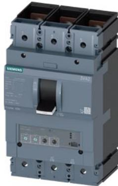
Interruttore 3VA2 IEC Frame 630 Classe del potere di interruzione L Icu=150kA @ 415V a 3 poli, protezione impianto ETU330, LIG, In=400A protezione da sovraccarico Ir=160A...400A protezione da cortocircuito li=1,5 ... 11x In protezione da guasto verso terra Ig=0,2...1 x In, tg=0,1/0,3s attacco piatto a vite
