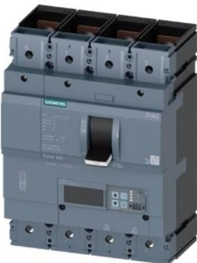
Interruttore 3VA2 IEC Frame 630 Classe del potere di interruzione C Icu=110kA @ 415V a 4 poli, protezione impianto ETU850, LSI, In=400A protezione da sovraccarico Ir=160A...400A protezione da cortocircuito Isd=0,6..10x In, li=1,5..15x In protezione del conduttore di neutro impostabile (OFF, fino al 160%) attacco piatto a vite
