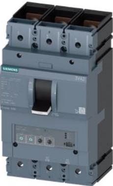
Interruttore 3VA2 IEC Frame 630 Classe del potere di interruzione C Icu=110kA @ 415V a 3 poli, protezione impianto ETU330, LIG, In=400A protezione da sovraccarico Ir=160A...400A protezione da cortocircuito Ii=1,5...12 x In protezione da guasto verso terra Ig=0,2...1 x In, tg=0,1/0,3s attacco piatto a vite
