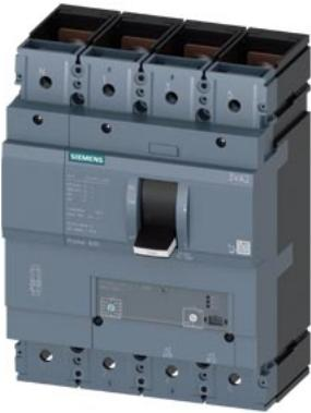
Interruttore 3VA2 IEC Frame 630 Classe del potere di interruzione C Icu=110kA @ 415V a 4 poli, protezione impianto ETU340, ELISA LI, In=400A protezione da sovraccarico Ir=160A...400A protezione da cortocircuito Ii=15 x In in protezione del conduttore di neutro impostabile (OFF, 50%, 100%) attacco piatto a vite
