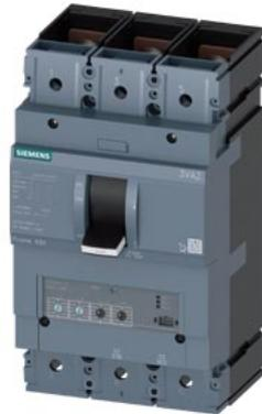
Interruttore 3VA2 IEC Frame 630 Classe del potere di interruzione H Icu=85kA @ 415V a 3 poli, protezione impianto ETU350, LSI, In=400A protezione da sovraccarico Ir=160A...400A protezione da cortocircuito I<sub>sd</sub>=1,5...10 x I<sub>r</sub>, I<sub>i</sub>=12 x I<sub>n</sub> attacco piatto a vite
