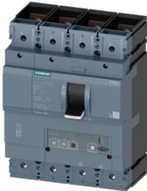
Interruttore 3VA2 IEC Frame 630 Classe del potere di interruzione H Icu=85kA @ 415V a 4 poli, protezione impianto ETU320, LI, In=400A protezione da sovraccarico Ir=160A...400A protezione da cortocircuito li=1,5...12 x In protezione del conduttore di neutro impostabile (OFF, 50%, 100%) attacco piatto a vite
