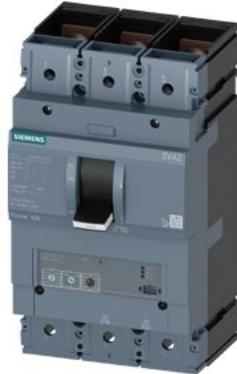
Interruttore 3VA2 IEC Frame 630 Classe del potere di interruzione M Icu=55kA @ 415V a 3 poli, protezione motore ETU350M, LSI, In=400A protezione da sovraccarico Ir=160A...400A protezione da cortocircuito I<sub>sd</sub>=3...15 x I<sub>r</sub>, I<sub>i</sub>=15 x I<sub>n</sub> attacco piatto a vite
