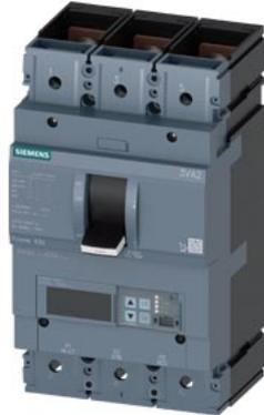
Interruttore 3VA2 IEC Frame 630 Classe del potere di interruzione M Icu=55kA @ 415V a 3 poli, protezione impianto ETU560, LSIG, In=400A protezione da sovraccarico Ir=160A...400A protezione da cortocircuito I<sub>sd</sub>=0,6..10x I<sub>n</sub>, I<sub>i</sub>=1,5..15x I<sub>n</sub> protezione del conduttore di neutro opzionale con trasformatore di corrente, fino a 160% protezione da guasto verso terra, disinseribile I<sub>g</sub>=0,2...1 x I<sub>n</sub>, tg=0,05-0,8s attacco piatto a vite
