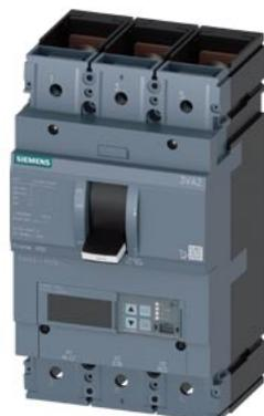
Interruttore 3VA2 IEC Frame 400 Classe del potere di interruzione L Icu=150kA @ 415V a 3 poli, protezione impianto ETU860, LSIG, In=400A protezione da sovraccarico Ir=160A...400A protezione da cortocircuito I<sub>sd</sub>=0,6..10x I<sub>n</sub>, I<sub>i</sub>=1,5..10x I<sub>n</sub> protezione del conduttore di neutro opzionale con trasformatore di corrente, fino a 160% protezione da guasto verso terra, disinseribile I<sub>g</sub>=0,2...1 x I<sub>n</sub>, tg=0,05-0,8s attacco piatto a vite
