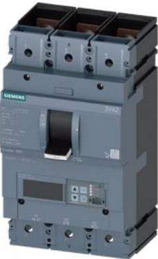
Interruttore 3VA2 IEC Frame 400 Classe del potere di interruzione L Icu=150kA @ 415V a 3 poli, protezione impianto ETU550, LSI, In=400A protezione da sovraccarico Ir=160A...400A protezione da cortocircuito Isd=0,6..10x In, li=1,5..10x In protezione del conduttore di neutro opzionale con trasformatore di corrente, fino a 160% attacco piatto a vite
