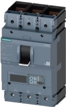
Interruttore 3VA2 IEC Frame 400 Classe del potere di interruzione H Icu=85kA @ 415V a 3 poli, protezione impianto ETU560, LSIG, In=400A protezione da sovraccarico Ir=160A...400A protezione da cortocircuito Isd=0,6..10x In, li=1,5..10x In protezione del conduttore di neutro opzionale con trasformatore di corrente, fino a 160% protezione da guasto verso terra, disinseribile Ig=0,2...1 x In, tg=0,05-0,8s attacco piatto a vite
