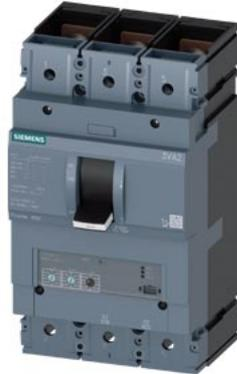
Interruttore 3VA2 IEC Frame 400 Classe del potere di interruzione H Icu=85kA @ 415V a 3 poli, protezione impianto ETU320, LI, In=400A protezione da sovraccarico Ir=160A...400A protezione da cortocircuito li=1,5...10 x In attacco piatto a vite
